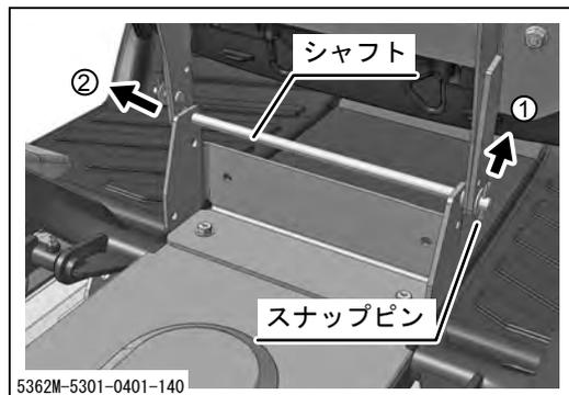
2. スナップピン①を外します。シートの蝶番ブラケットを固定しているシャフトを②の方向へ引き抜きます。シートを取り外します。
