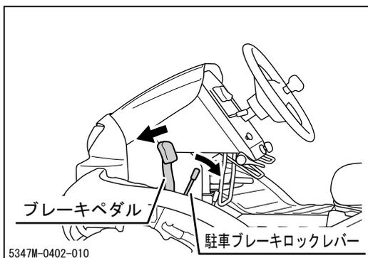
3. ブレーキペダルを踏み込み、駐車ブレーキロックレバーを手前に引いてブレーキペダルをロックします。
