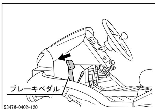
3. ブレーキペダルを踏み込んで、車両を完全に停止します。
