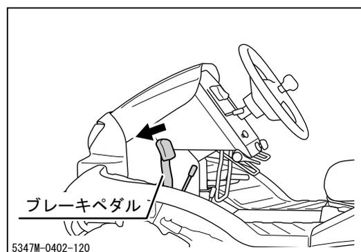
4. ブレーキペダルを奥まで踏み込み、駐車ブレーキロックレバーを解除します。
