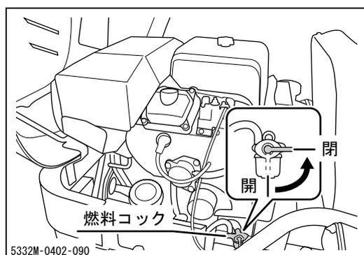
5. エンジンカバーを開け、燃料コックを[閉]にし、エンジンカバーを閉じます。
