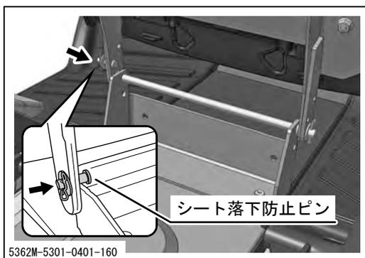
1. シートを上げ、シート落下防止ピンを内側に押し込みシートを固定します。
