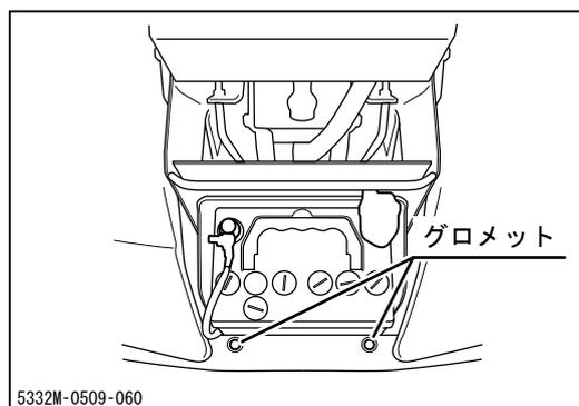
5. 取り付け時はヘッドランプユニットの底面の突起をバンパーのグロメット穴に挿入し、取り外しと逆の要領で取り付けます。
