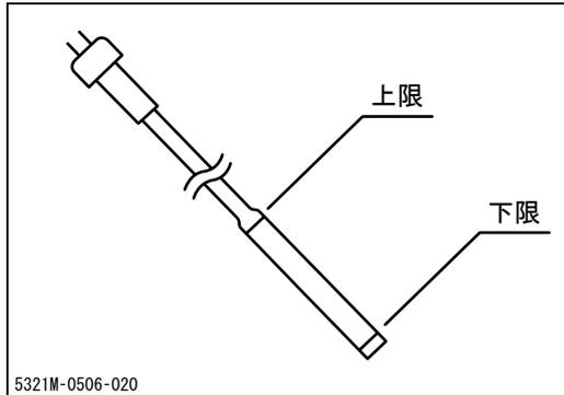
5. オイル量を目視点検し、オイルレベルゲージの上限と下限の間にあることを確認します。下限より少ない場合は補給します。
