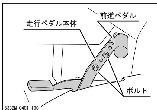
1. 走行ペダル本体に前進ペダルを取り付けているボルト（2本）を外します。
