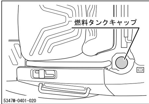
2. 燃料タンクキャップを開け、燃料を補給します。
