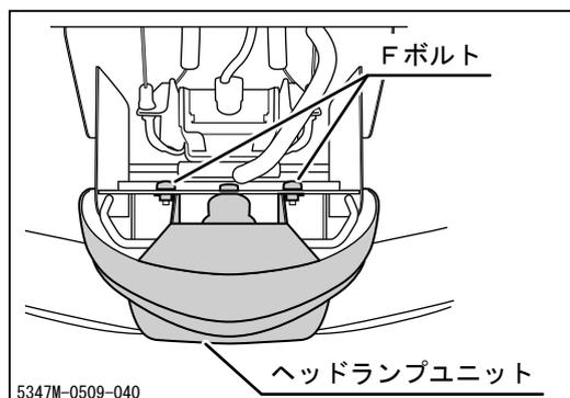
4. ヘッドランプユニットを固定しているFボルト2本、カプラを取り外し、ヘッドランプユニットを取り外します。
