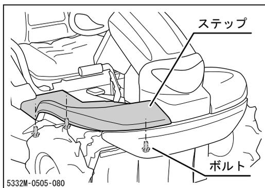
1. ステップを取り付けているボルト（3本）を外します。
