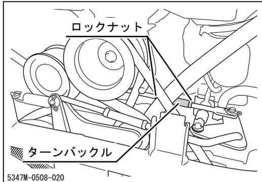
5. ワッシャーの位置がノッチと合っていない場合は、ロックナットを緩めターンバックルを調整します。
