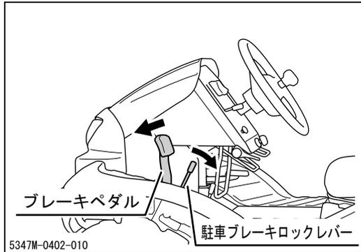
1. ブレーキペダルがロックされていることを確認します。ロックされていない場合は、ブレーキペダルを踏み込み、駐車ブレーキロックレバーを手前に引いてロックします。
