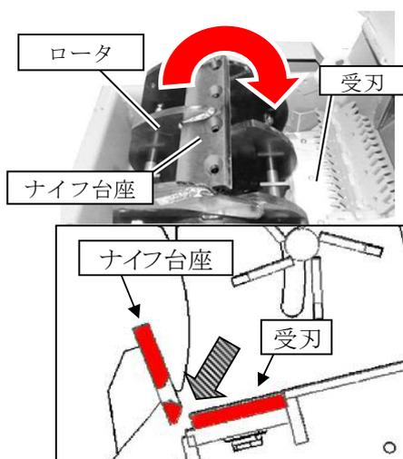
8. 付属のゲージ2枚を重ねて（150mmスケールの厚みで）受刃とナイフ台座の隙間（1.0mm）を調整します。受刃を動かし隙間調整をしてください。
