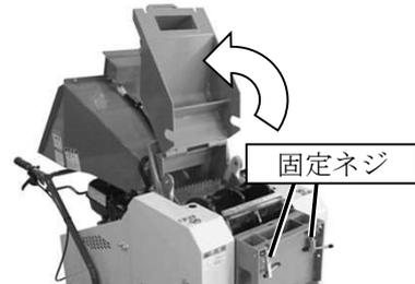
2. 投入口方向から見て左側面土台のフレームよりロータロックピンを抜き取ります。
