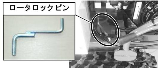
3. ロータロックピンをロータハウジングの内側から挿し込み、ロータを固定して、チッパナイフ（2枚）を取り外してください。
