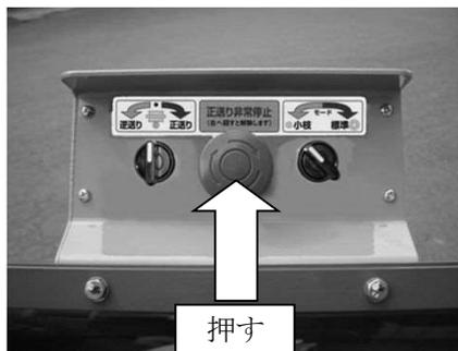
2. エンジン非常停止スイッチは、右へ回すと解除します。(スイッチが元の位置に飛び出します。)
