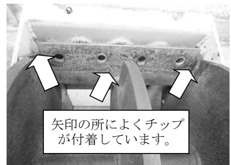
7. チップナイフを取り外した状態で、ロータのナイフ台座と受刃の隙間調整をして下さい。P30『受刃の反転・交換・調整』の要領で行ってください。
