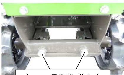
4. クローラ張りボルトを回して、クローラと転輪の隙間（図中A）が10～15mm程度（転輪が水平な状態で）になるよう調整します。
