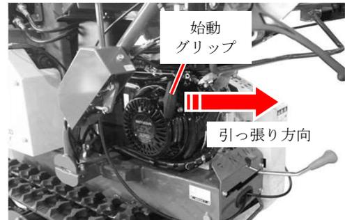
8. エンジン始動後、負荷をかけずに2～3分程低速で暖気運転をしてください。
