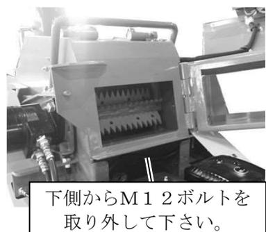
6. 受刃を反転、または交換しM12の受刃固定ボルト（3本）を軽く締めます。（受刃台座が長穴になっております）
