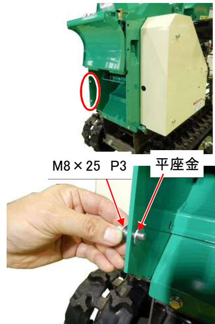
3. 安全ガードを挿入し、2. と反対側はM8 × 25 P3のボルトを挿し込み仮締めして下さい。
