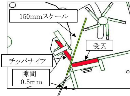
10. 調整後、チップナイフの六角穴付皿ボルト(各4ヶ)を締付けトルク  $110\text{N}\cdot\text{m}$  で締めてください。
