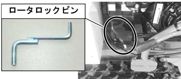
4. ロータを回しロータロックピンが挿せる位置にしてください。ロータロックピンをロータハウジングの左右のどちらかの穴位置に差し、ロータが回らないようにロックしてください。
