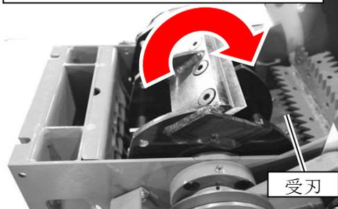
12. チップナイフの反転、または交換、調整後は、ロータロックピンとロータカバー、投入口のホッパを元に戻し、固定ネジをしっかりと締め付けてください。
