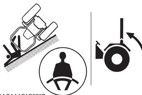
6. 安全フレームを改造しないでください。又、強度に影響する破損、曲がりなどが発生した場合、交換してください。
